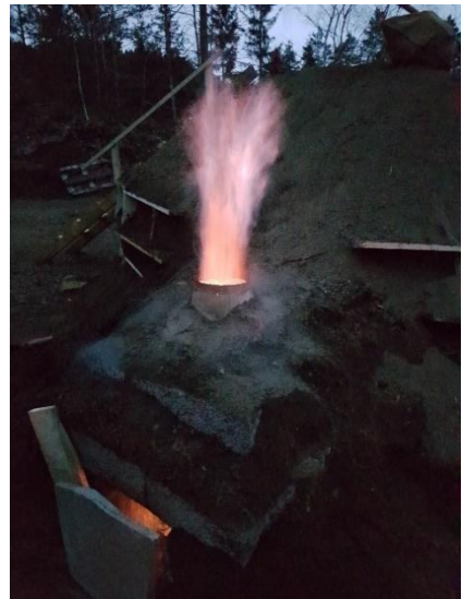
Zinkbøtte som midlertidig skorsteinstopp.
