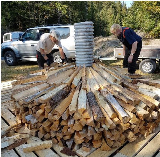
Veden ble lagt som en vifte rundt tennkanalen.
