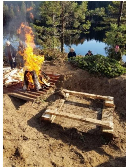
Bål på toppen av kullmila med luke til tennkanalen. Granbar ligger klart.
