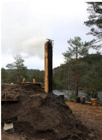
Pipe av tre er montert på skorsteinen.
